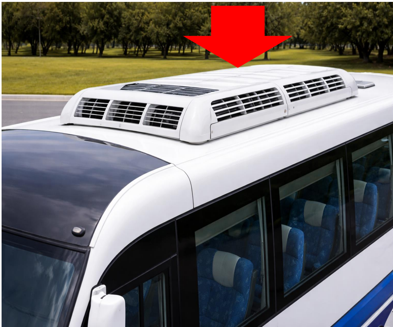
Imagem Ilustrada do Local de Instalação do Ar-Condicionado
