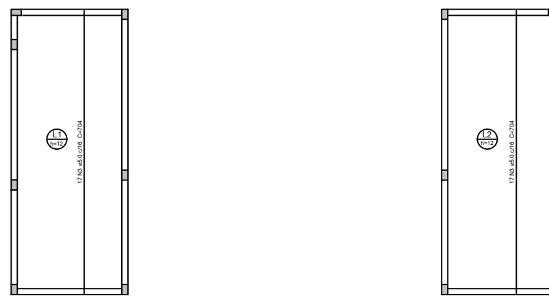
Armação positiva das lajes do pavimento TERREO (Eixo Y)
