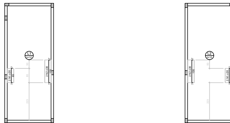
Armação negativa das lajes do pavimento TERREO (Eixo Y)
