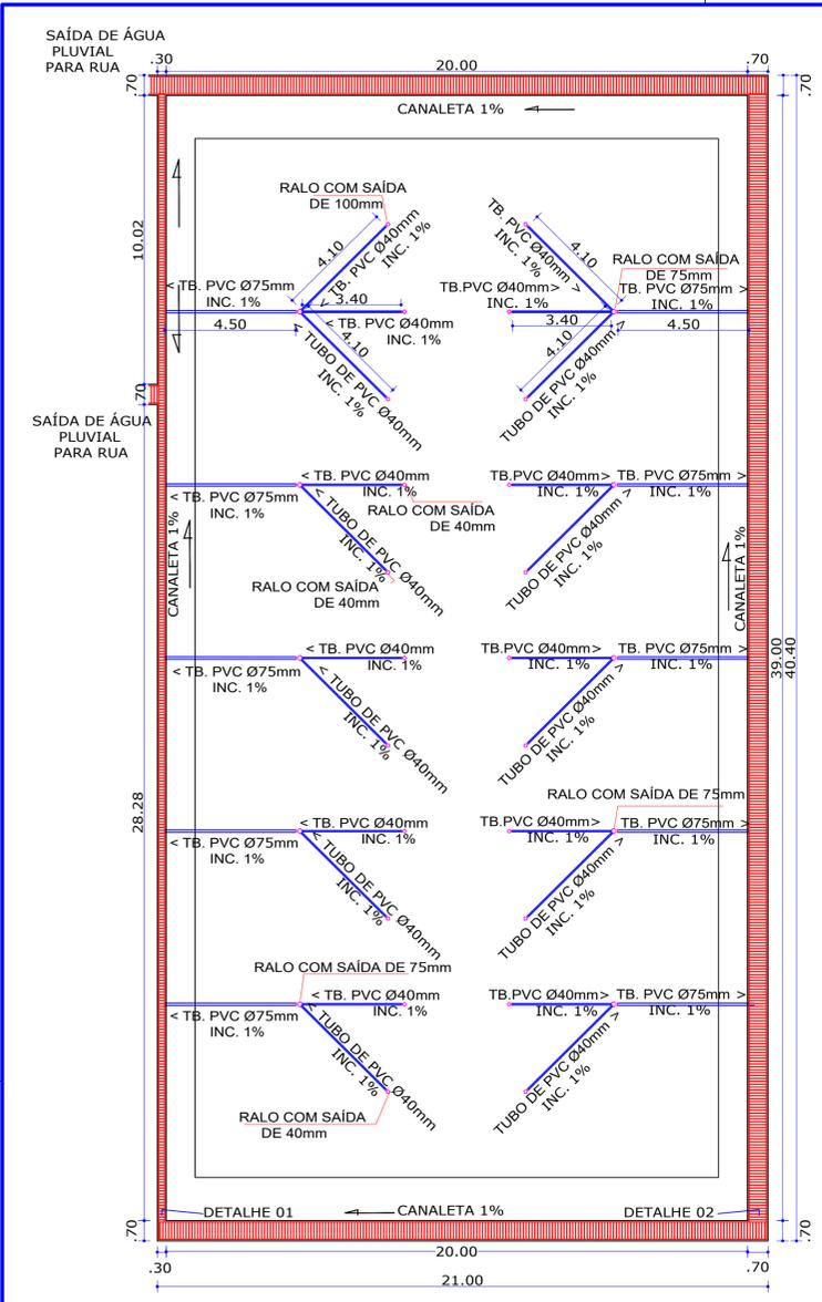
**SISTEMA DE DRENAGEM PARA ÁGUAS PLUVIAIS**
